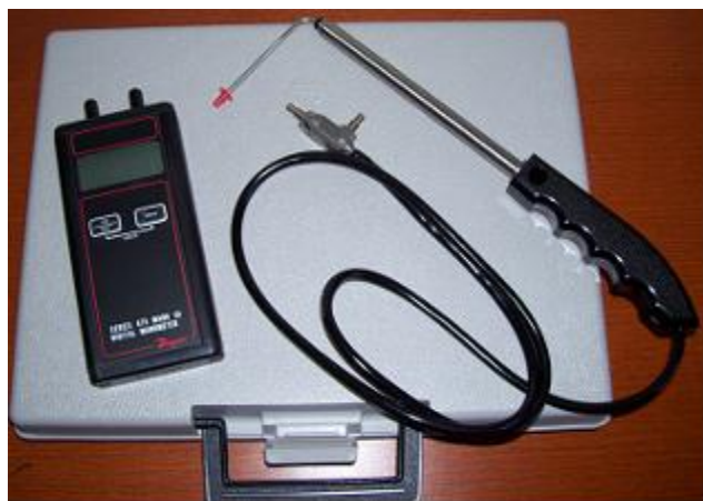
Figura 39: Tubul Pitot (și manometru Digital) utilizat la evaluarea sistemului de abur
