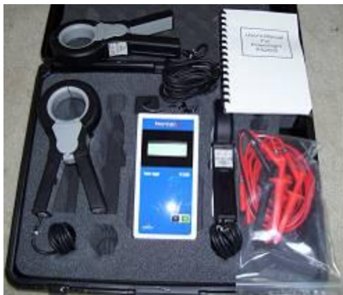
Figura 41: Contor de putere portabil pentru utilizarea într-un sistem de evaluare a aburului
