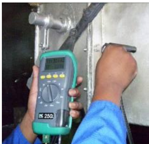
Figura 40: Utilizarea unui Analizator de depistare a gazelor din coș pentru evaluarea sistemului de abur
